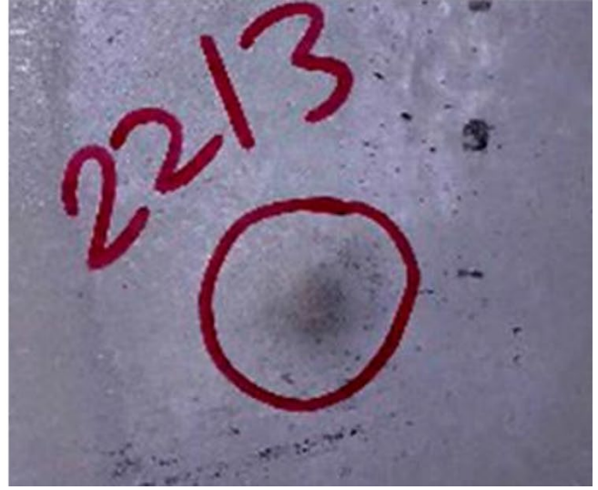
Şekil: 12. 2 atıştan sonra Tanık Plakasının arkadan görünümü Sonuç: Kabul edildi
