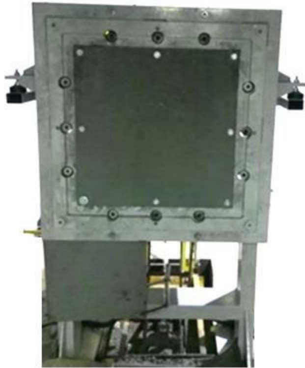
Şekil: 25. 500 mm x 500 mm Test Panellerinin Hedef Sabitleme Sistemi
